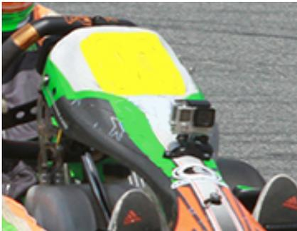
La position de montage sur le panneau avant est fixée horizontalement, dans l'axe médian, et à au moins 10 cm en dessous du bord inférieur de la zone numérique du panneau. La caméra ne doit pas obstruer la vue du numéro de face.
